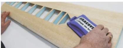
Abb. 2 Abschleifen der Oberfläche
